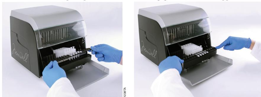
**Figure 53.** Placez le portoir dans l'appareil.
