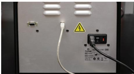
Figure 15. Branchez la tablette au dos de l'appareil Maxwell® CSC.
