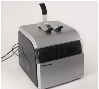
Figure 13. Support de la tablette placé sur l'appareil Maxwell® CSC.
