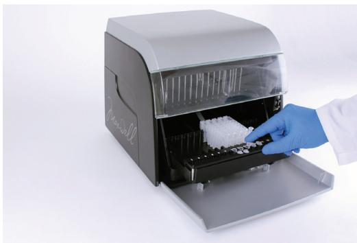
**Figure 57. Fermeture des capuchons des tubes d'élution.**
