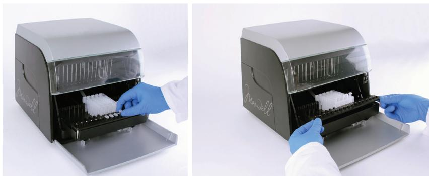
**Figure 58. Retrait des tubes d'élution et du portoir de la plateforme.**
