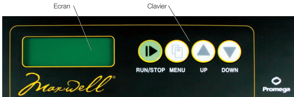
Figure 2. Ecran de l'appareil Maxwell® 16. L'écran LCD et le clavier, qui comprend les boutons Run/Stop (Exécuter/ Arrêter), Menu, les boutons de défilement vers le haut (up), vers le bas (down), sont illustrés.
