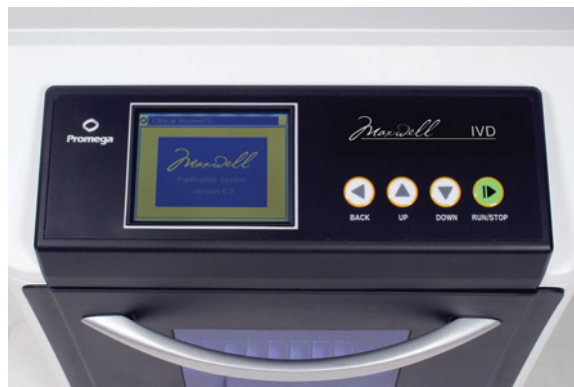
Figure 3. L'écran tactile et le clavier utilisés pour parcourir les différents écrans affichés sur l'appareil Maxwell® 16 IVD. Les mêmes sélections de boutons sont disponibles sur le clavier et l'écran. Les deux jeux de boutons peuvent être utilisés pour la navigation au sein des écrans et entre ceux-ci. Les boutons « Back » (retour) et « Run/Stop » (Marche/arrêt) permettent la navigation entre les écrans. Les boutons « Up » (défilement vers le haut) et « Down » (vers le bas) permettent la navigation au sein d'un écran.
