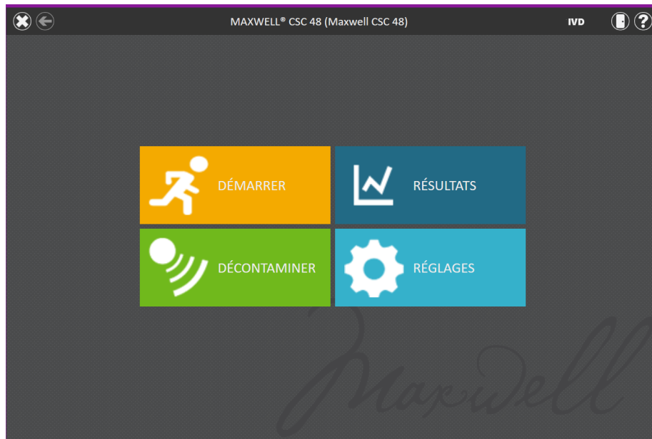
Figure 32. Écran « Accueil » de Maxwell® CSC 48. Le bouton Démarrer permet de lancer un cycle d'une méthode d'extraction sur le Maxwell® CSC 48 Instrument.
