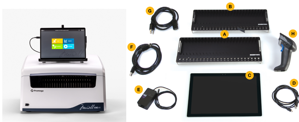
Figure 1. Maxwell® CSC 48 Instrument. Les éléments illustrés sont les suivants : Portoir (avant ; A), portoir (arrière ; B), tablette (C), câble USB (D), adaptateur d'alimentation pour tablette (E), câble de communication pour le lecteur de codes barres (F), câble d'alimentation pour tablette (G) et lecteur de codes barres (H).
