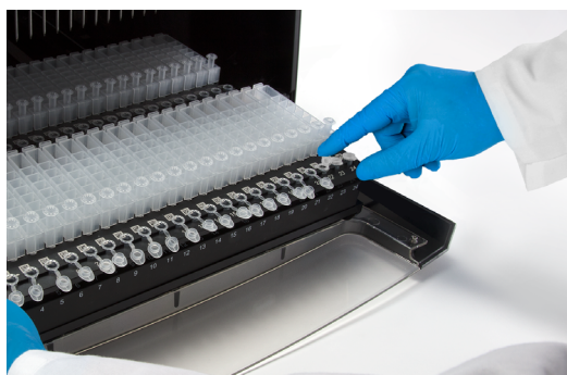
Figure 45. Fermeture des bouchons des tubes d'élution.
