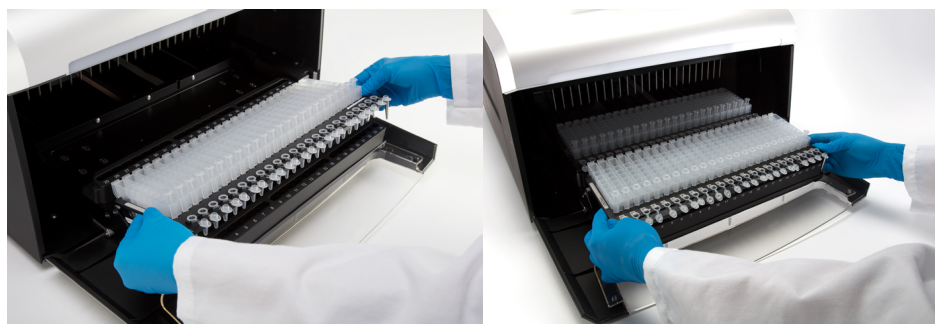
Figure 42. Placement du portoir de la plateforme dans l'appareil.
