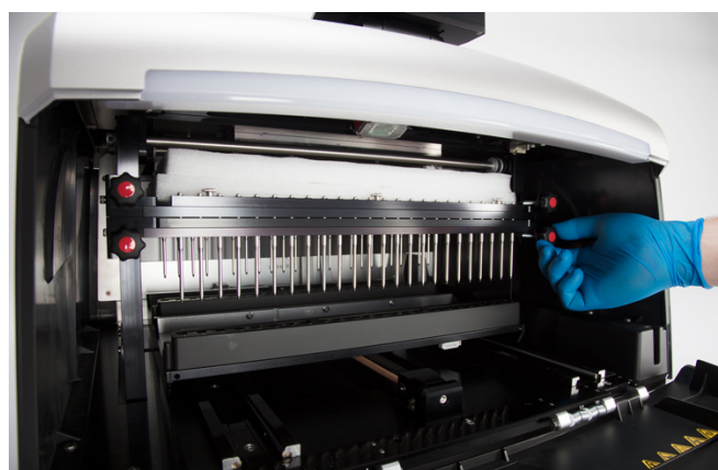
Figure 63. Mise en place des butées en plastique. Déplacez les barres des aimants et des plongeurs vers le haut et fixez les quatre vis d'expédition des deux côtés des barres des aimants et des plongeurs.
