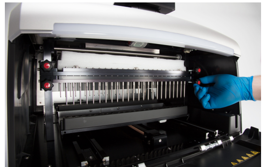
Figure 7. Retrait des deux morceaux de mousse de l'intérieur de l'appareil. Panneau A. Retirez le morceau de mousse supérieur. Panneau B. Retirez les quatre vis d'expédition des côtés de l'aimant avant et des barres de plongeurs.
