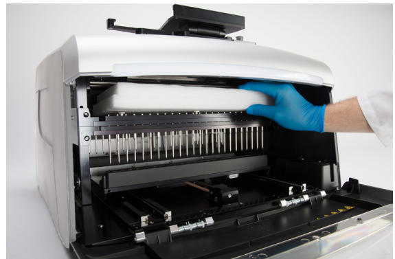
Figure 8. Retrait du morceau de mousse supérieur de l'appareil. Déplacez l'aimant et les barres de plongeurs vers le bas pour retirer le morceau de mousse supérieur.
