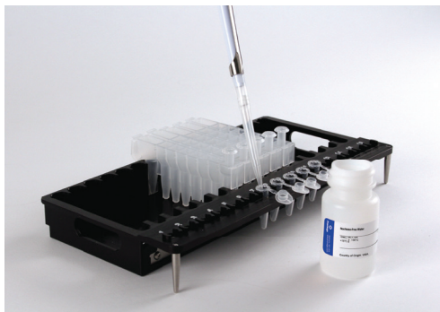
Figure 1. Installation et configuration du plateau. De la Nuclease-Free Water est ajoutée aux Elution Tubes comme indiqué. Ouvrez les Elution Tubes avant de commencer une méthode d'extraction.
