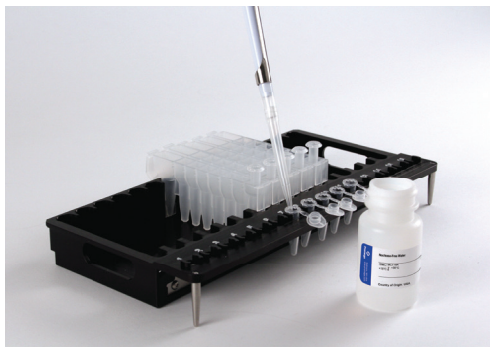
Figure 7. Installation et configuration du plateau. De la Nuclease-Free Water est ajoutée aux Elution Tubes comme indiqué. Ouvrez les Elution Tubes avant de commencer la méthode d'extraction.
